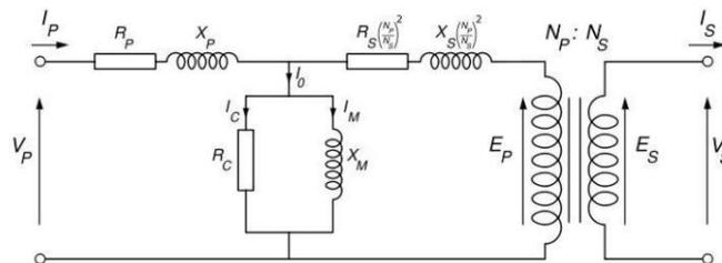
Gambar 2.10. Rangkaian Ekuivalen Transformator
