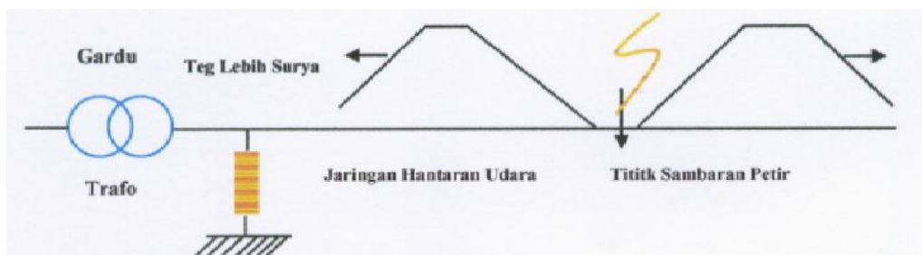
Gambar.2.3. Sambaran Tegangan Surja Petir
