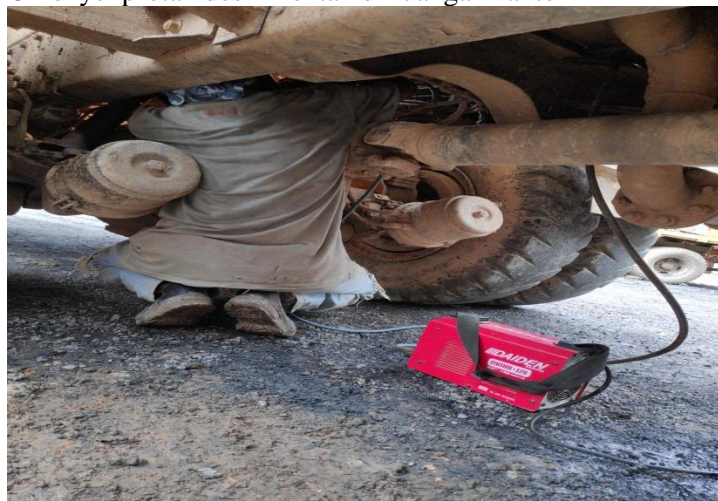
Gambar 14 Perbaikan Water Tank
